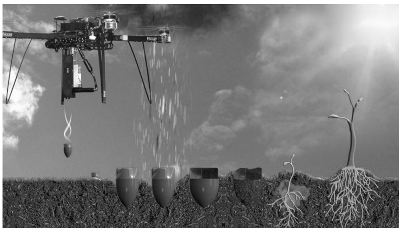
Рисунок.1. Технология посадки леса при помощи БПЛА.
